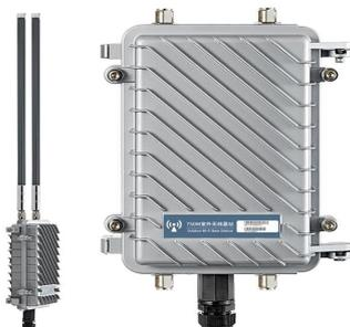
ZP-270GW 是一款高性能防水户外基站，支持 802.11AC 技术。可在 2.4G/5.8G 频段工作，满足 80 人同时无线高速上网的需求。100M 网络接口，2.4G 802.11N 300Mbps + 5G 802.11AC 450Mbps 无线接入速度，无线处理速度可达 750Mbps。
