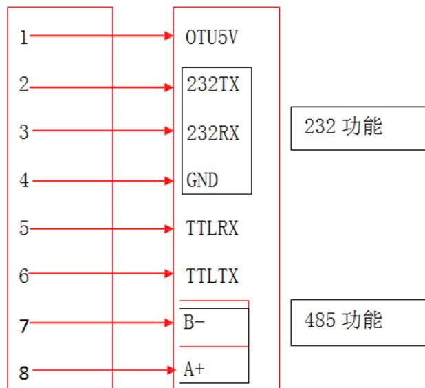
RS232 功能: ZP-LX08R 的网口线序是 2, 3, 4 脚 (2 脚: 232TX; 3 脚: 232RX; 4 脚: GND); 对应网线口的线序 2, 3, 4 脚 (2 脚: 232TX; 3 脚: 232RX; 4 脚: GND)。
